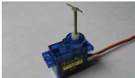
links een servo met standaard armpje, rechts de servo met een 2mm boutje op de as en een stukje koperstaaf in de gleuf
