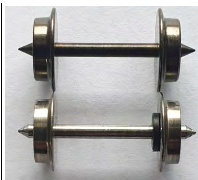
figuur 6: boven 3-railwiel onder 2-railwiel
