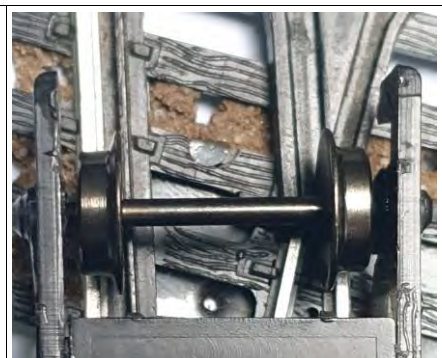
figuur 8: 3-railwiel op 2-railwissel (NEM)
