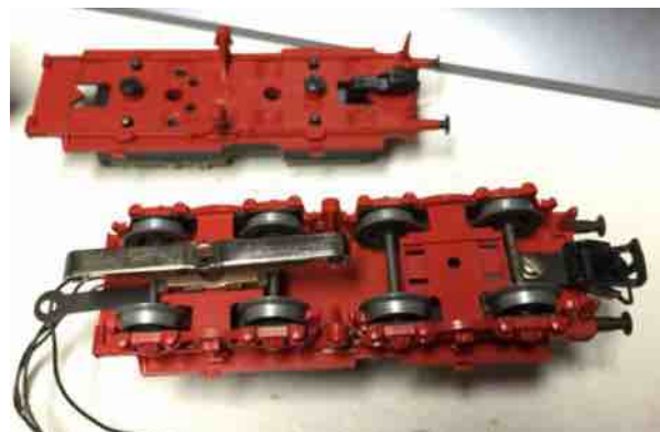
fig. 6: de bodemplaat van de BR 03 en het onderstel van de tender van de BR50
