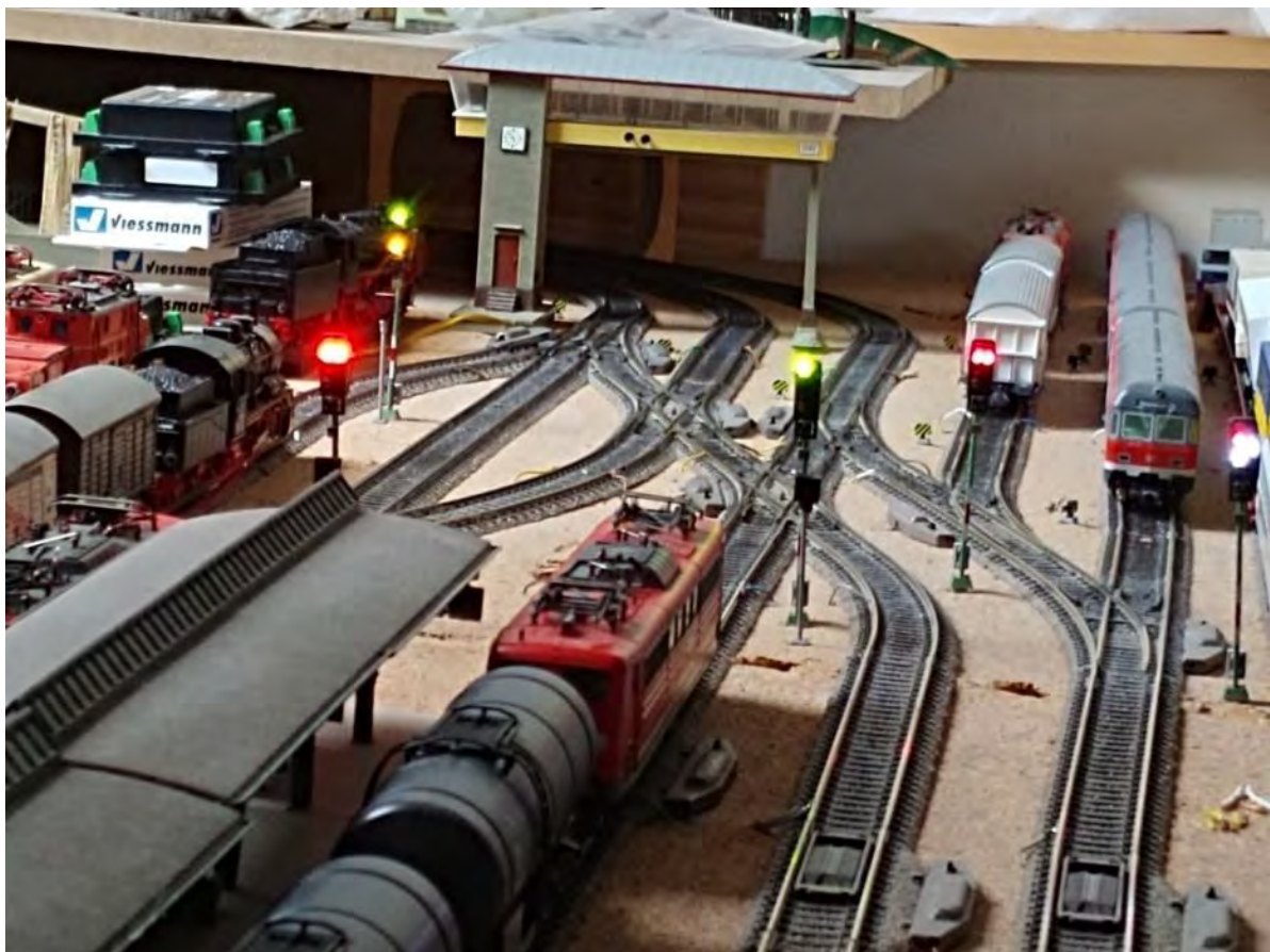
Figuur 5: Foto van mijn modelbaan, waarbij er bepaalde uitrijseinen op veilig staan op basis van ingestelde rijwegen. Hierbij zetten de treinen na het passeren van het sein via detectie de seinen weer op onveilig.
