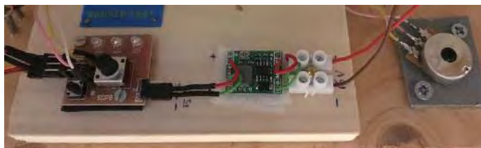
links de ontmantelde tester, midden de step-down module, rechts van het plankje de potmeter voor bediening door publiek
