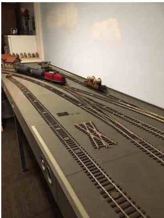
De lay-out van het linkergedeelte van de Spoor 1 baan. Met de platte schijven tussen de spoorstaven is de rails provisorisch vastgelegd. Na het ballasten gaan deze ringen er uit.
