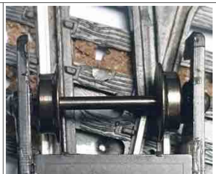
figuur 8: 3-railwiel op 2-railwissel (NEM)
