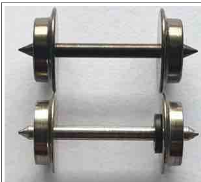
figuur 6: boven 3-railwiel onder 2-railwiel
