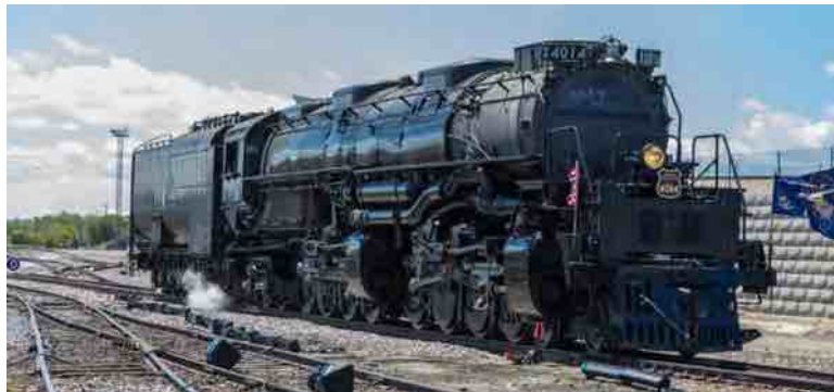
Deze 'flinke jongen' verdient zijn naam dubbel en dwars. Met zijn lengte van 40 m. inclusief de tender, was de Big Boy twee keer langer dan de grootste Europese of traditioneel Amerikaanse locomotieven.
