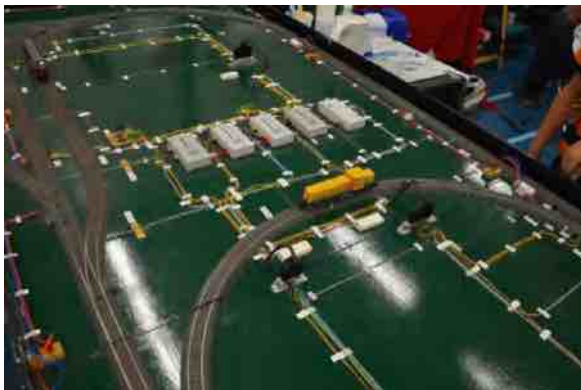
Figuur 1: Voorbeeld van een digitaal aangestuurde baan met treindetectie. Hier een baan van HCC.
