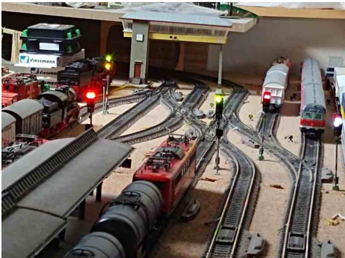
Figuur 5: Foto van mijn modelbaan, waarbij er bepaalde uitrijseinen op veilig staan op basis van ingestelde rijwegen. Hierbij zetten de treinen na het passeren van het sein via detectie de seinen weer op onveilig.
