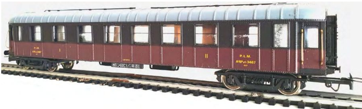
1e-2e klas rijtuig; hier nog met originele disselkoppeling en te korte vouwbalg
